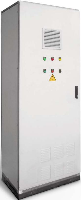
**Серия ProSS** – Универсальный шкаф управления, оснащенный устройством плавного пуска, обеспечивающая управление группой нагрузок с постоянной скоростью, осуществляющая все необходимые технологические и электрические защиты, как электродвигателя, так и управляемого механизма мощностью до 315 кВт напряжением 380В и 690В. (Возможно изготовление ШУ ProSS мощностью до 800кВт)
