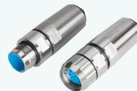
Разработан с учетом требований пищевой промышленности: степень защиты IP 67, контакты с золотым напылением и плоская поверхность для надежной передачи электроэнергии и сигналов во влажной среде.
