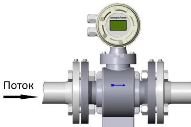
Рисунок 6 – Горизонтальное положение при установке
